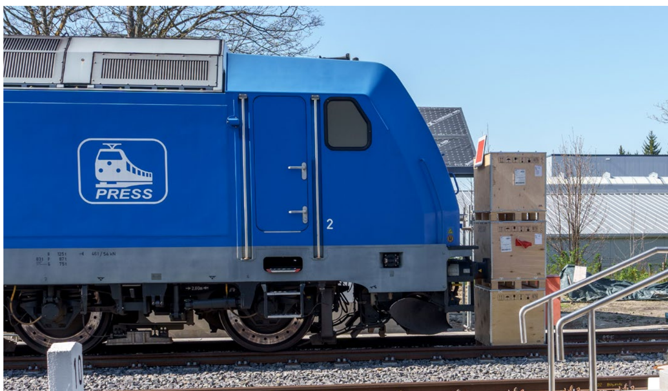
Bild 3: Testfahrzeug der Baureihe 285, vor einem aufgebauten Hindernis
